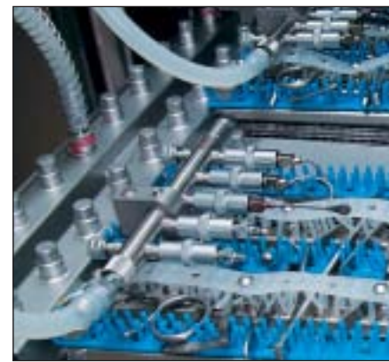
Abbildung 3: Durchspülen von Augenkanülen (Mischkonzept).
