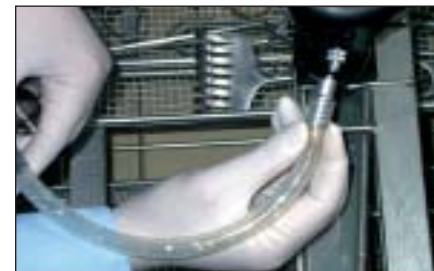
Abbildung 10: Schritt V: den Luerlock mit dem Anschluss verbinden.
