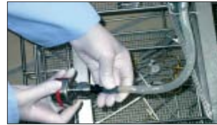
Abbildung 11: Schritt VI: Druck-/Temperaturlogger an den Schlauch anschließen (hier verwendeter Logger von Ebro).
