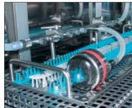
Abbildung 4: Druckprüfung einer Spüleiste mit seitlichen Spülanschlüssen (Mischkonzept).
