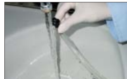
Abbildung 9: Schritt IV: den Anschlussschlauch des Loggers mit Wasser befüllen.
